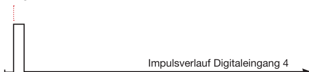
Abb.: Prinzip Impulsverlauf am Digitaleingang 4 - steigende Flanke
