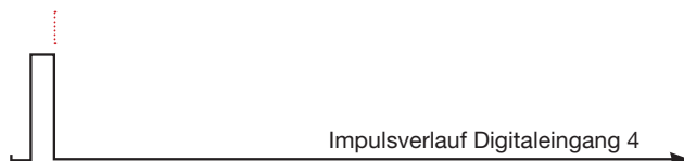
Abb.: Prinzip Impulsverlauf am Digitaleingang 4 - fallende Flanke
