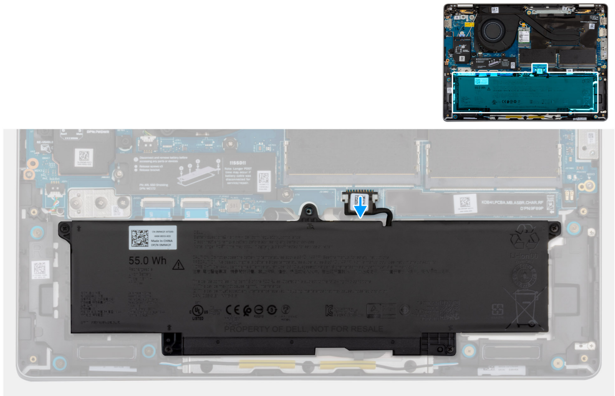
Abbildung 24. Trennen des Akkukabels
