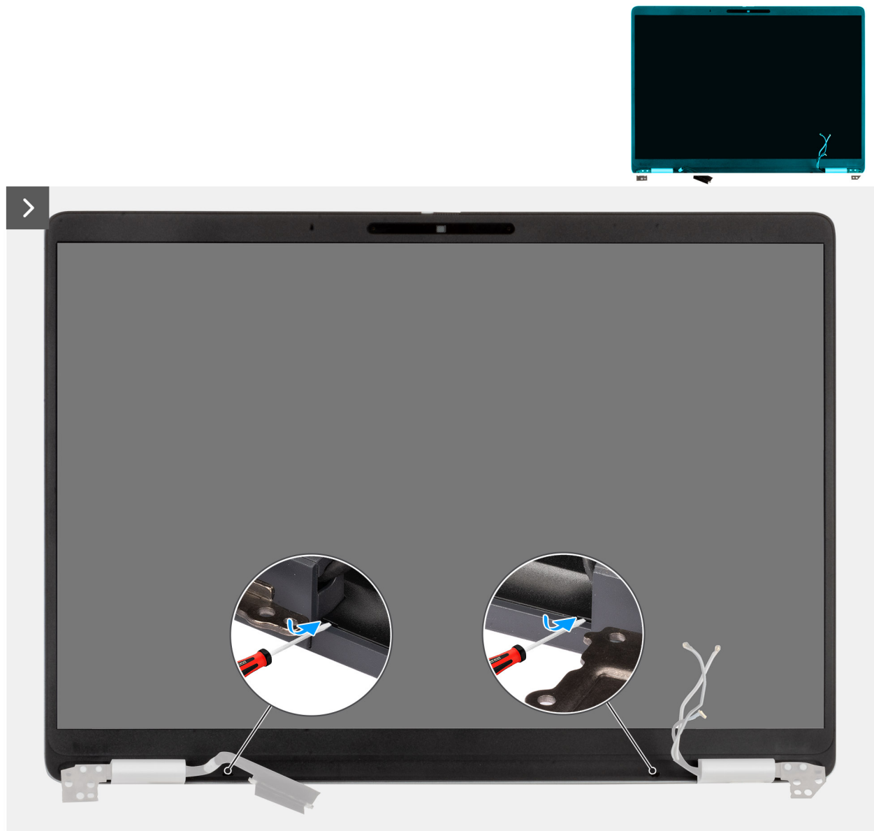
Abbildung 68. Entfernen der Bildschirmblende
