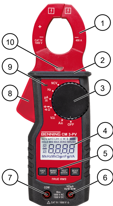
Afbeelding 1: Opbouw van het apparaat BENNING CM 3-PV
