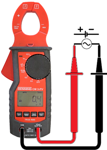
Abb.: Strommessung über Sicherheitsmessleitungen ( \mu\text{A} ) Figure: Current measurement via safety measuring lines ( \mu\text{A} ) Illustration : Mesure de courant au moyen des câbles de mesure de sécurité ( \mu\text{A} ) Afbeelding: Stroomsterktemeting m.b.v. de veiligheidsmeetkabels ( \mu\text{A} )
