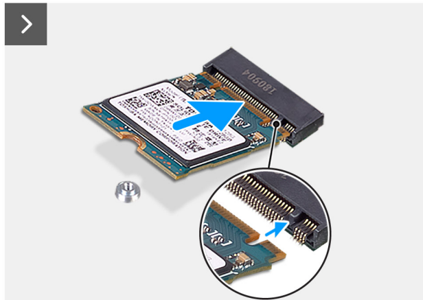
Abbildung 33. Einbauen des M.2 2230-PCIe-SSD-Laufwerks
