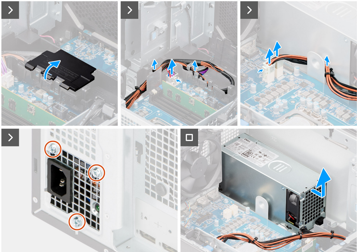
Abbildung 58. Entfernen des 360-W-Netzteils
