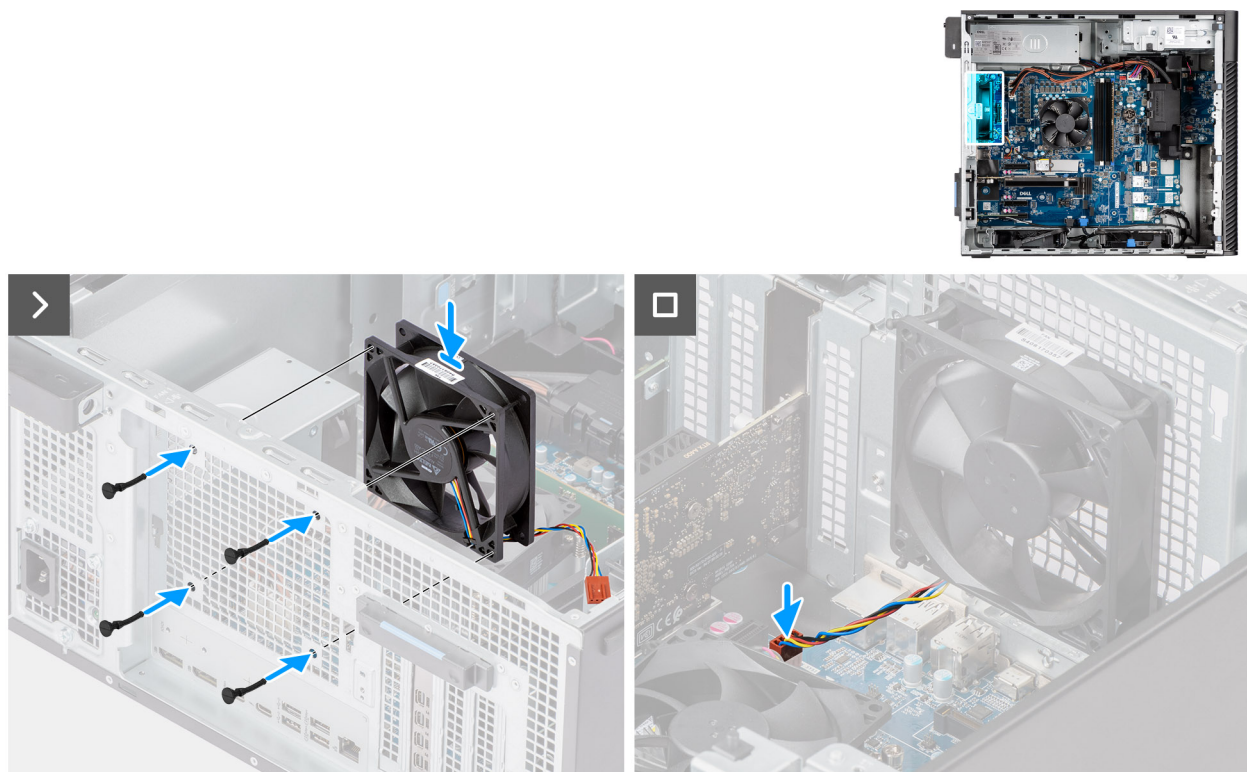
Abbildung 51. Installieren des hinteren Lüfters bei Computern mit 360-W-Netzteilen
