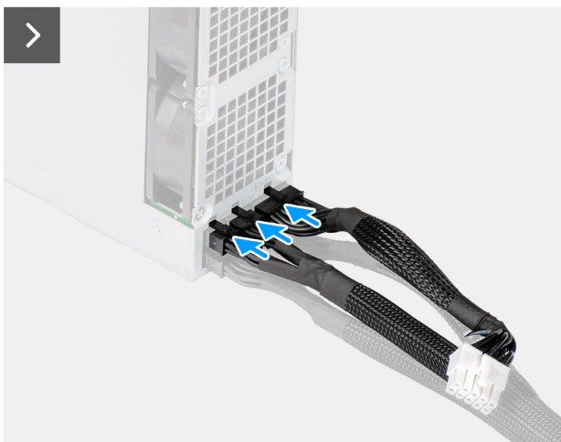
Abbildung 56. Installieren des 1.500-W-Netzteils
