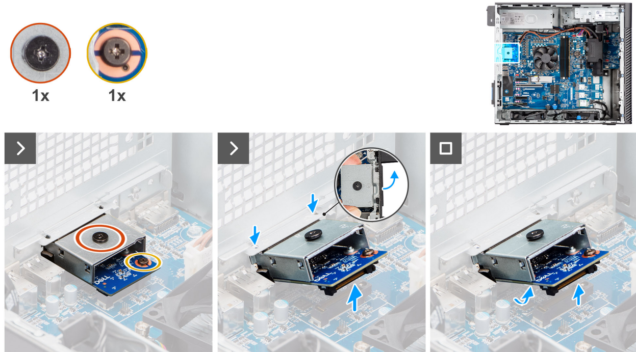
Abbildung 86. Entfernen des optionalen VGA-Moduls
