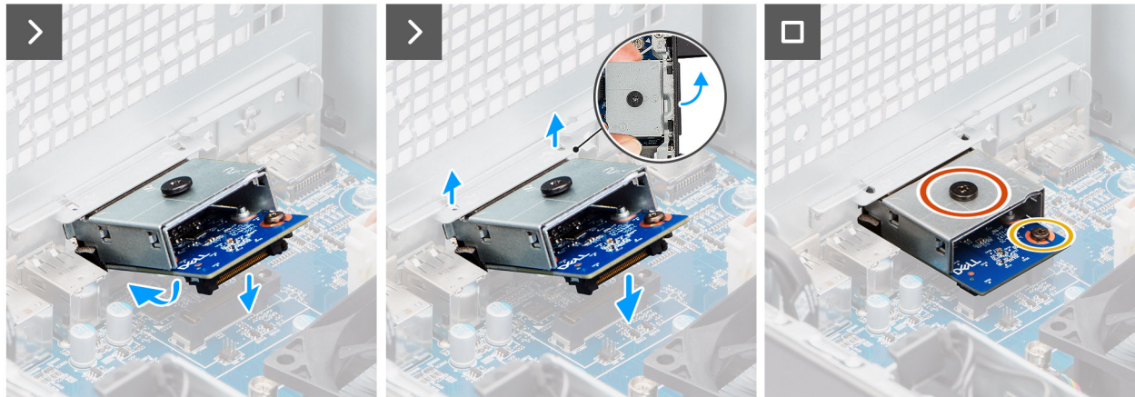
Abbildung 88. Installieren des optionalen VGA-Moduls
