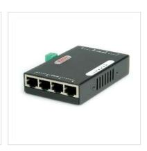
Mit diesem ROLINE Gigabit Ethernet PoE Injektor können gleichzeitig vier PoEfähige Workgroupswitches, Netzwerk-Kameras, Access Points, IP-phones, etc. über die TP-Anschlussleitung mit Strom versorgt werden.
