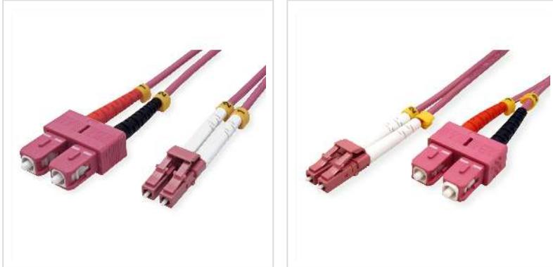
**Die OM4 Faser wird für bestehende 1 und 10 Gbit/s-Anwendungen, sowie zukünftige 40 und 100 Gbit/s verwendet. Für größere Reichweiten von über 550m bei 10 Gbit/s und Backbones geeignet. Mit einer effektiven Modalen Bandbreite von 4700 MHz-km, ist die OM4 Faser auch besonders gut für kürzere Reichweiten in Rechenzentren geeignet, sowie für High Performance Computing-Anwendungen.**
