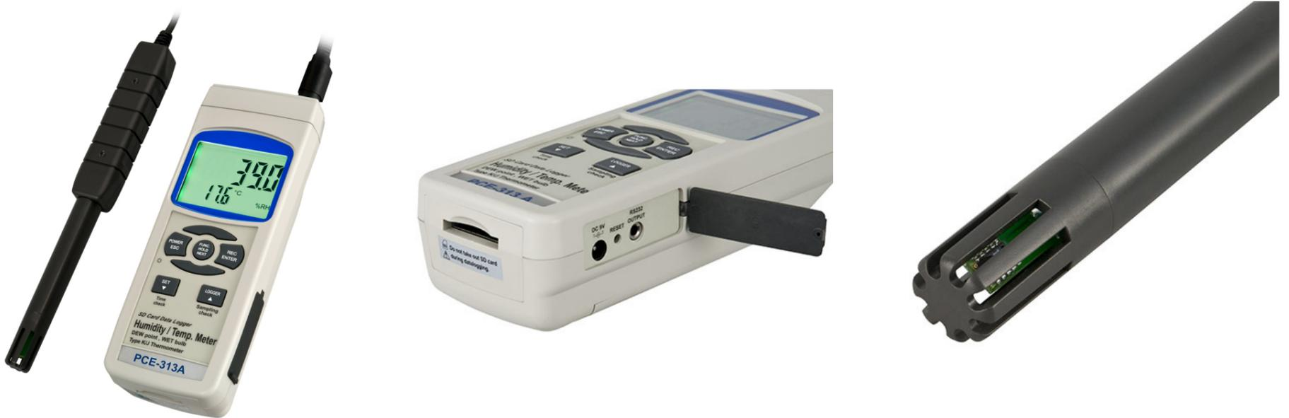
**Feuchtelogger für relative Feuchtigkeit u. Temperatur interner Messwertspeicher über SD-Karte (1 ... 16 GB) / Datenschnittstelle zur Onlineübertragung / Batterie oder Netzbetrieb möglich / zusätzlicher K-Typ Thermoelement-Anschluss**
