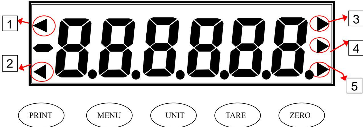
1. Zero-Statusanzeige, wird angezeigt, wenn die Waage im Null-Band befindet.
