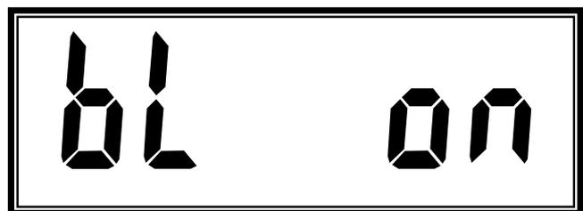
Beleuchtung on bzw. Off. Mit der Taste **PRINT** bestätigen Sie die Einstellung.
