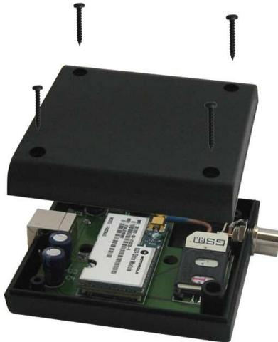
Bei dem **Gehäuse zur Montage auf 32 mm Tragschiene** (Hutschiene) befindet sich der SIM- Kartenhalter auf der rechten Seite des Gehäuses.
