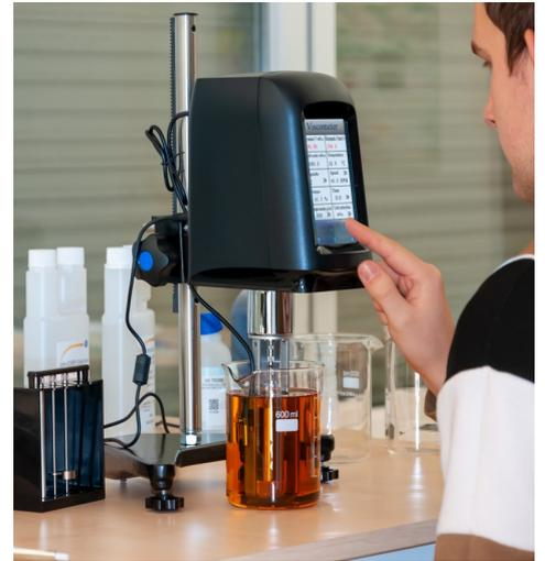
Präzises Viskosimeter mit Touchscreen / Temperatursensor / Laborständer / Messbereich bis 2.000.000 mPa·s / 5 verschiedene aufsetzbare Spindeln / zur Messung der Viskosität von Flüssigkeiten / RS232 Schnittstelle
