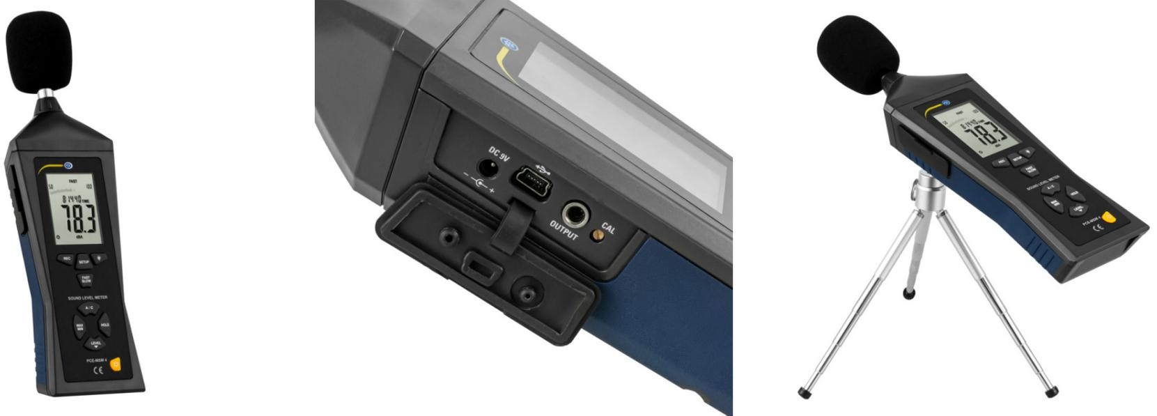
**Einsteiger- Schallpegelmessgerät für den industriellen Einsatz / A und C Frequenz-Bewertung / 4-stelliges LCD zur Anzeige der Lautstärke / hohe Genauigkeit von  $\pm 1,4$  dB / Messbereich von 30 ... 130 dB**
