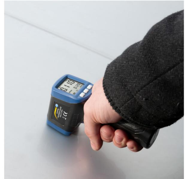
**Schichtdickenmessgerät mit komfortabler Einhandbedienung / MIN MAX und MEAN Anzeige /
