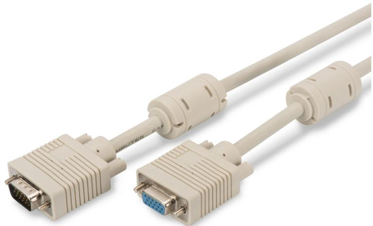
**VGA Monitor Verlängerungskabel, HD15 St/Bu, 3.0m, 3Coax/7C, 2xFerrit, be**
