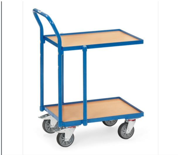
Etagen-Roller mit 2 Plattformen aus Holzwerkstoffplatte im Rahmen liegend, Rand 15 mm hoch. Pulverbeschichtet blau RAL 5007. Lichter Etagenabstand 500 mm. Tragkraft obere Ladefläche 80 kg. 4 Lenkrollen mit TPE-Bereifung, Naben mit Rillenkugellager. 2 Stück mit Feststeller, gemäß der Europäischen Norm EN 1757-3 (Sicherheit von Plattformwagen). Passend für Eurokästen 600 x 400 mm. Zerlegte Anlieferung.
