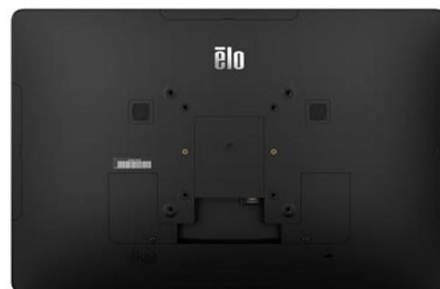
Dank universeller VESA-Halterung und Elo Edge Connect-Kompatibilität ermöglicht die I-Serie 4 den Anschluss von einer Vielzahl von Zubehörgeräten wie Bezahlterminals, Kameras und Strichcodeleser. Damit können Elo-Kunden die I-Serie für praktisch jeden Einsatzzweck problemlos konfigurieren.
