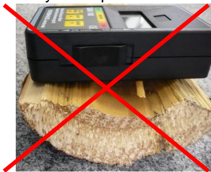
Hibás: Deformált felület (itt extrém módon!)
