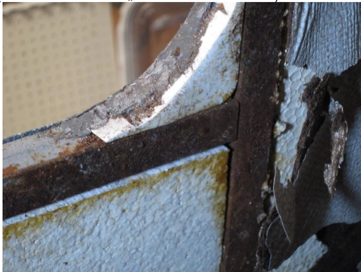
Régebbi lakókocsik szigetelése és fém vázszerkezete
