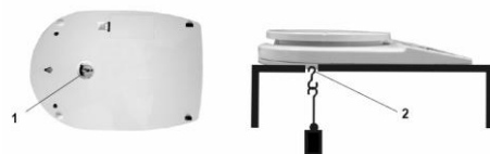
1. ábra: A mérleg elrendezése akasztós mérlegként
