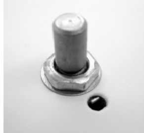
A kapcsolós hangerőszabályzó (potencióméter)
