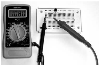
73. ábra: Egyszerű multiméterrel csak durva becslést tehet azzal kapcsolatban, hogy egy tranzisztor rendben van-e. Egy NPN-tranzisztor vizsgálatához tegye a piros mérőszinórt a báziscsatlakozásra, a feketét váltakozva a kollektorra és az emitterre.
