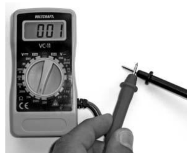
50. ábra: Ha összetartja a két mérőszinór hegyét, az ellenállásmérésre beállított multiméter 0,0 \Omega vagy 0,01 \Omega értéket mutat. Ez a vezeték folytonosságát jelzi, mivel megközelítőleg nincs ellenállása.
