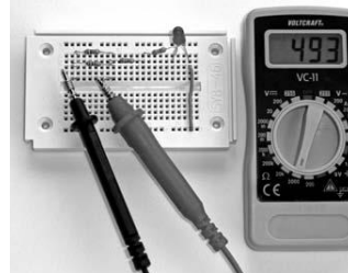
57. ábra: A kapcsolásban egymással párhuzamosan kötött két 1 k \Omega -os ellenállásnak az itt 493 \Omega értékű eredő ellenállását lehet csak megmérni.
