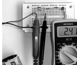
55. ábra: Mindegy, hogy a párhuzamosan kapcsolt ellenállásokon egyenként, vagy közösen mérje meg a feszültségessé, mindegyik esetben azonos értéket kap.
