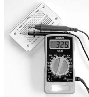
27. ábra: Ha a helyes mérési tartományt állítja be, a második, eredetileg 1 k \Omega -nak mért ellenállásról kiderül, hogy az egy 330 \Omega -os ellenállás.
