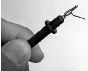
23. ábra: Kereken 7 cm hosszúságú csupasz huzaldarabot tekerjen a mérőcsúcsok köré.
