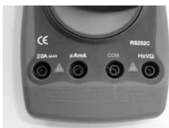
17. ábra: A legtöbb multiméteren 3-4 mérőhüvely van kialakítva, amelyekre a két mérőzsinór a végzendő méréstől függően dugható rá.
