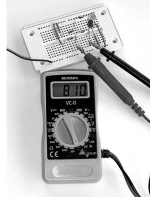
72. ábra : A Voltcraft VC-11 műszer a dióдаvizsgálati-funkció egy másik lehetőségét nyújtja. Ha megjelenik egy mérési eredmény, a dióдаt áteresztőirányban méri.
