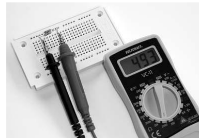
33. ábra: Két párhuzamosan kapcsolt 1 kΩ-os ellenállás eredő ellenállásául 493 Ω adódik ki. Az, hogy ez az érték nem pontosan 500 Ω, az ellenállások gyártási tűréséből adódik.
