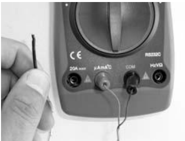
79. ábra: A fekete mérőszinórt a COM-hüvelyre dugja rá. A piros mérőszinórt a ΩmA°C hüvelyre kell dugni.
