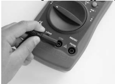
17. ábra: A legtöbb multiméteren 3-4 mérőhüvely van kialakítva, amelyekre a két mérőzsinór a végzendő méréstől függően dugható rá.
