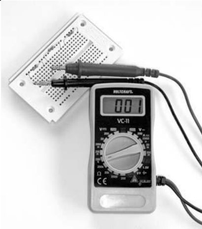
25. ábra: A beállítható legnagyobb mérési tartományban a mérési eredmények még eléggé pontatlanok.
