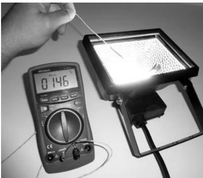
80. ábra: Itt egy halogén fénysugárzó mellett levegő-hőmérséklet mérése folyik. Csak a huzalos hőmérsékletérzékelő hegyén lévő érzékelő viseli el a magas hőmérsékleteket.
