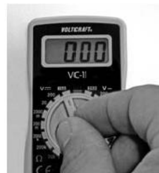
21. ábra: Minden egyes mérés előtt kapcsolja először a műszert a maximális mérési tartományba. Ennél a műszernél ez egyenfeszültség mérésekor 250 V.
