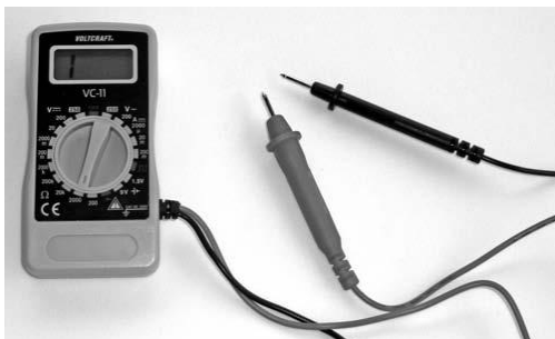
51. ábra: Egymástól eltávolított mérőszinórok esetében az ellenállás végtelen nagy, amit a „1” kijelzés mutat. Ez kábelszakadást, vagy többeres kábel esetén meg nem talált eret jelezne.
