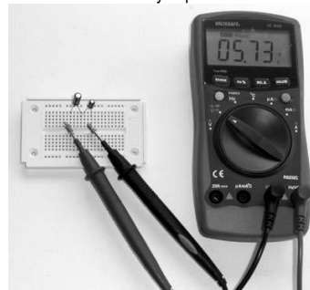
37. ábra: A két elkö beépítésekor figyeljen a kondenzátorok polaritására. A mérőszinórokat is helyes polaritással kell csatlakoztatni.
