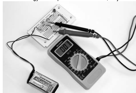
63. ábra: Ennek a kapcsolásnak a mért teljes árama 4,87 mA. Ez a három egymással párhuzamosan kötött, majd velük sorba kötött ellenálláson és a LED-en átfolyó teljes áram.
