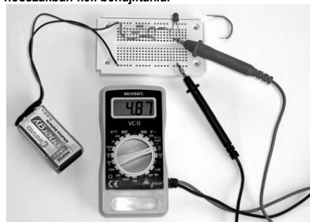
63. ábra: Ennek a kapcsolásnak a mért teljes árama 4,87 mA. Ez a három egymással párhuzamosan kötött, majd velük sorba kötött ellenálláson és a LED-en átfolyó teljes áram.
