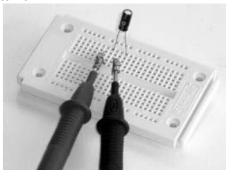
34. ábra: A kondenzátorokat csak a kapcsoláson vagy áramköri részen kívül
