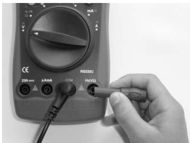
19. ábra: Ha feszültséget- és ellenállást kell mérnie, ennél a műszernél csatlakoztassa a piros mérőzsinórt a jobboldali, HzVΩ feliratú hüvelyre. Kis áramok méréséhez dugja a mérőzsinórt a μAmA feliratú hüvelybe.
