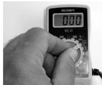
20. ábra: Vigyáznia kell a helyes mérési érték (pl. „egyenáram”, ha egyenáramot fog mérni) kiválasztására.
