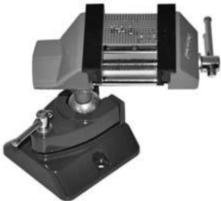
19. ábra : A műszerészsatuba befoghatja a kártyát, és kényelmesen forraszthat rajta.
