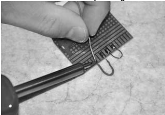
31. ábra: Huzaláthidalások beforsztása az oldalsó forrcsík-raszterre
