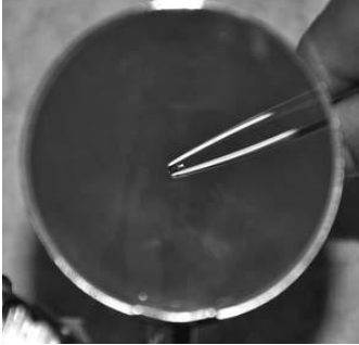
45. ábra: Még a nagyító alatt is nagyon kicsi az SMD-dióda.
