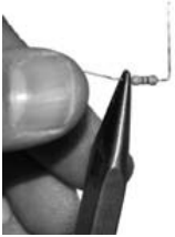
30. ábra : Az elektromos alkatrészeknél nem szabad a huzalokat közvetlenül a ház mellett meghajlítani.
