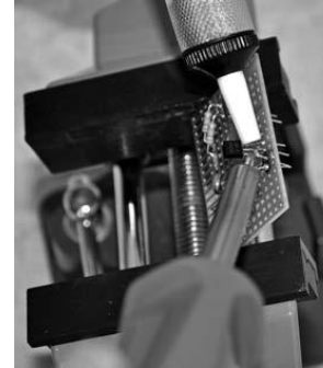
57. ábra: A forrasztóónrögöket felhevítés és az ónszippantó pumpával történő elszívás útján lehet eltávolítani.
