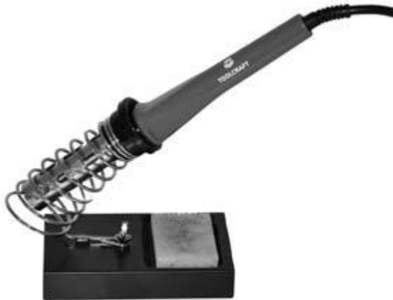
18. ábra: Stabil forrasztópáka-állvány pákaszivaccsal az elszennyeződött pákahegy tisztítására
