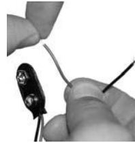
26. ábra: Először sodorja meg az elemi szálakat az ujjai között.
