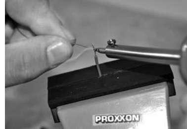
27. ábra: Melegítse fel a sodrott huzalt, és tartson hozzá egy kis forrasztóónt is, amely azonnal megolvad.
