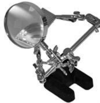
20. ábra : A nagyítós forrasztóállvány is rögzíti a kártyát.
