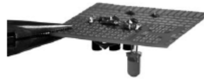
63. ábra : A csatlakozóhuzalokat valamivel a forrasztási kúp felett vágja le.
