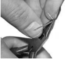
29. ábra: A huzalt egy elektronikai műszerészfogóval hajlítsa meg
