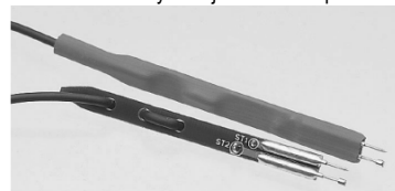
38. ábra: Speciális mérőcsúcsok az akku belső ellenállásának méréséhez
