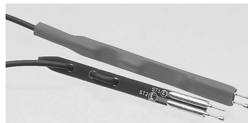
7. ábra: Speciális mérőcsúcsok az akku belső ellenállásának méréséhez
