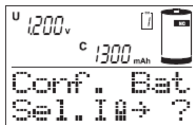
26. ábra: Menü a kisütő áram beállításához
