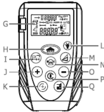
F. Övtartó G LC-kijelző H. Mérőgomb I. Felület-, térfogat- és kitűzés funkció J. Összeadás / Felfelé elmozdítani K. Mértékegység / maximum és minimum kapcsoló L. Háttérvilágítás Lézermutató kapcsoló M. Közvetett mérés N. Hanghatás kioldó/ Tároló lekérdezés [O] Kivonás / Lefelé elmozdítani P. Főkapcsoló / Törlés Q. Műszer vonatkozási alappont / Zummer kapcsoló
