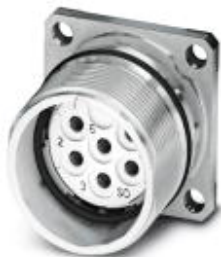
Készülékcsatlakozó, előső fal, egyenes, árnyékolt: van, SPEEDCON reteszelés, M23, Pólusszám: 6, Csatlakozási mód: Aljzat, Krimpcsatlakozás, Lapos tömítés, 4xØ3,2
