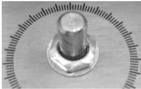
2.3 ábra Az anyával rögzített tengely
