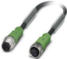
Szenzor/aktor kábel, 3-pólusú, PUR halogénmentes, feketésszürke RAL 7021, Csatlakozó egyenes M12, A-kódolás, a Aljzat egyenes M12, A-kódolás, Kábelhossz: 0,3 m
