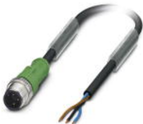
Szenzor/aktor kábel, 3-pólusú, PUR halogénmentes, feketésszürke RAL 7021, Csatlakozó egyenes M12, A-kódolás, a szabad vezetékvég, Kábelhossz: 10 m
