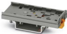
Hordozósínre szerelhető adapter, Szélesség: 28,6 mm, Magasság: 11 mm, Szín: szürke, Szerelési mód: NS 35/7,5, NS 35/15
