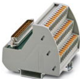
VARIOFACE modul, direkt rugós csatlakozásokkal és D-SUB-miniatűr aljzattal, NS 35 hordozósínrre szereléshez, pólusszám: 25
