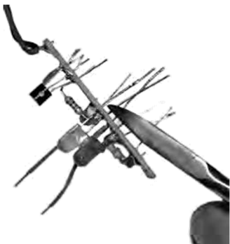
61. ábra: A kivezető huzalok felesleges hosszát az elkészített és ellenőrzött kapcsolat után egy elektronikus laposfogóval le kell csípni.
