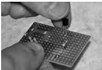
54. ábra: A tranzisztorok berakásakor figyeljen a korrekt beépítési helyzetre.
