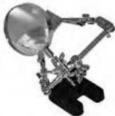
20. ábra: A forrasztássegítők nagyítóval szintén szilárdan tartják a kártyát.
