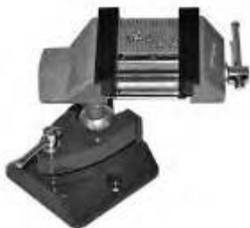
19. ábra: IA finomműszerészsatuba befoghatja a kártyákat és kényelmesen forraszthatja.
