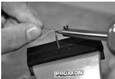
26. ábra: Melegítse fel a sodrott huzalt, és tartson hozzá egy kis forrasztóónt is, amely azonnal megolvad.
