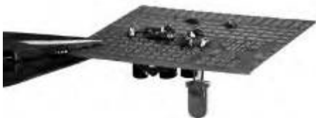
63. ábra : A csatlakozóhuzalokat valamivel a forrasztási kúp felett vágja le.
