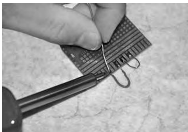
30. ábra: Huzaláthidalások ráforrasztása oldalsó csíkraszterre.
