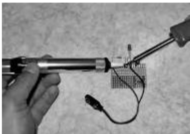
42. ábra: Nagy forraszmennyiséget, pl. itt az áthidalás az ellenállás és LED között, csak egy ónszippantó pumpával lehet eltávolítani.
