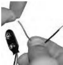
25. ábra: Először sorolja meg az elemi szálakat az ujjai között.
