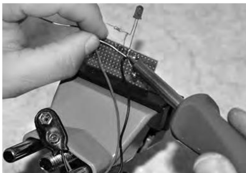
40. ábra: A két külső érintkező felületen az elemcsat huzaljait a még szabad furatokon keresztül kell dugni és beforszítani.
