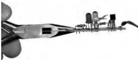
62. ábra: A rövidre vágott kivezetések még kb. 0,5 –1 milliméternyit álljanak ki a kártyából.
