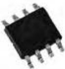
16. ábra: Az SMD-IC 1. csatlakozóérintkezőt (PIN 1) a ház tetején látható pont jelöli.
