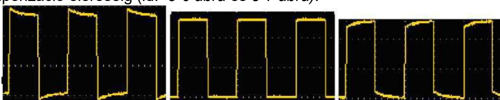
3-6 ábra A kijelzett hullámalakok a mérőfej kompenzációja
