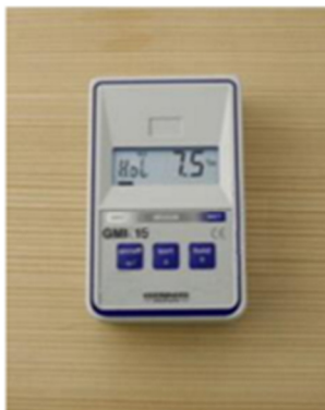
2 ábra: ráfektetve – helyes !
