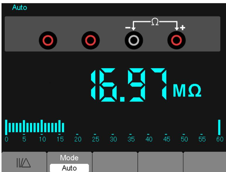
Figura 7-2 Misurazione Resistenza
