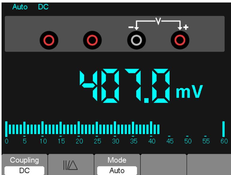
Figura 7-6 Misurazione Tensione DC
