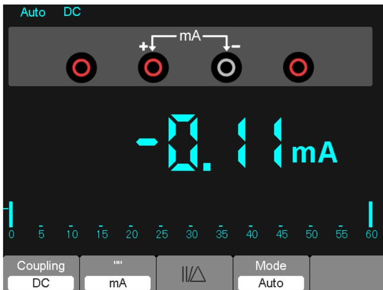
Figura 7-8 Misurazione corrente DC per 600 mA
