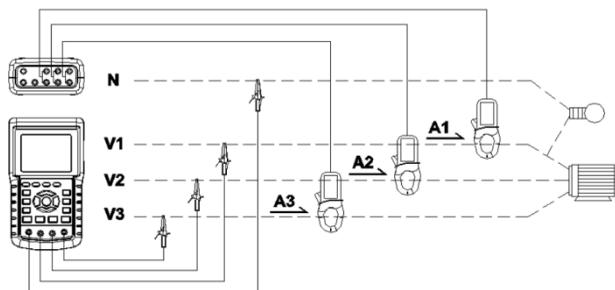
1. Accendere lo strumento premendo il tasto 'Power' (elemento 3-7; Sezione 3 disegni) e poi premere '1Φ 3Φ' (elemento 3-22) per selezionare il sistema 3Φ 4 W, il nome del sistema selezionato apparirà nella parte inferiore sinistra del display.
