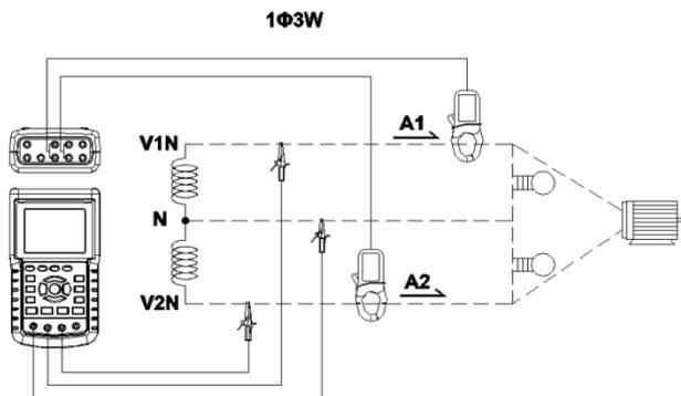
1. Accendere lo strumento premendo il tasto 'Power' (elemento 3-7; Sezione 3 disegni), e poi premere il tasto '1Φ 3Φ' (elemento 3-22) per selezionare 1Φ 3W, il nome selezionato della configurazione apparirà nella parte inferiore sinistra del display.
