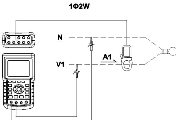
1. Accendere lo strumento premendo il tasto 'Power' (elemento 3-7; Sezione 3 disegni) e poi usare il tasto '1 $\Phi$  3 $\Phi$ ' (elemento 3-22) per selezionare il sistema 1 $\Phi$  2 W, il nome selezionato del sistema sarà mostrato nella parte inferiore sinistra del display (consultare Figura 5-1 qui sotto).
