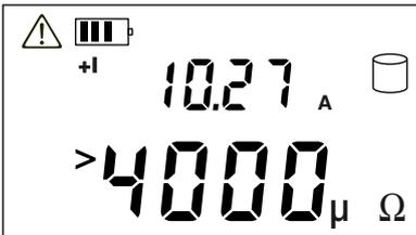
Se l'apparecchio indica un superamento di calibro (simbolo >), ruotare allora il commutatore sul calibro seguente, e riavviare la misura. Continuare fino alla visualizzazione del messaggio di superamento del calibro.
