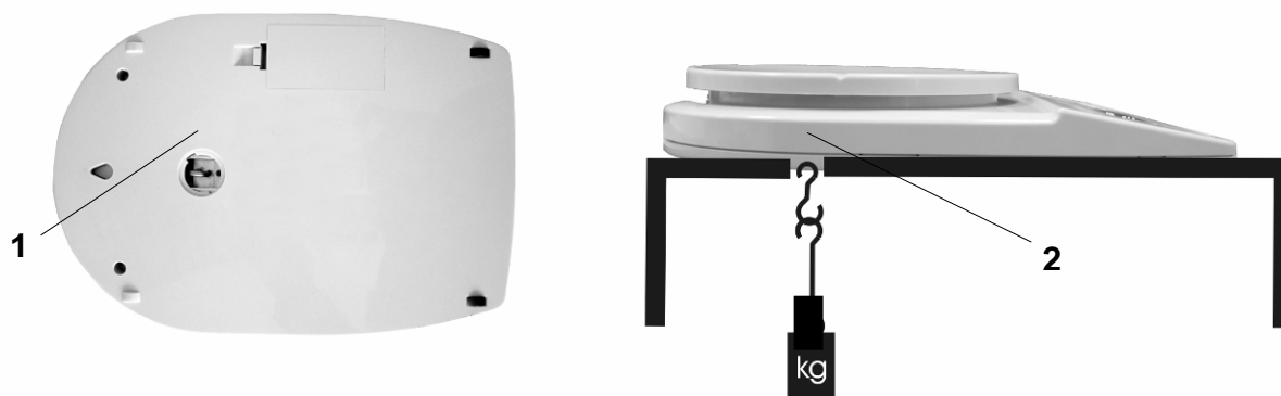
Fig. 1: Regolazione della bilancia per pesature sottobilancia
