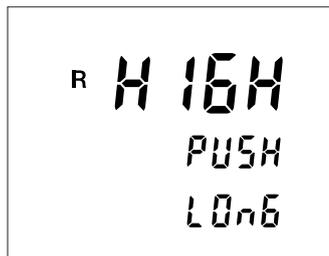
Questo messaggio si visualizza quando la misura è stata avviata da una pressione breve sul bottone START/STOP e quando le resistenze dei picchetti sono troppo elevate. Occorre allora avviare la misura effettuando una pressione prolungata sul bottone START/STOP. Il strumento misura allora il valore dei picchetti e lo compensa per visualizzare il risultato corretto.
