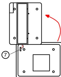
7. Disinserite il connettore “4 punti” della batteria tirando leggermente la linguetta. Evitate ogni contatto delle mani con il circuito e relativi componenti.
