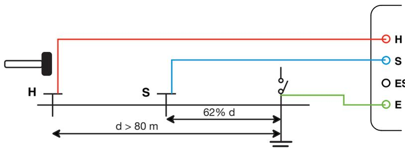
Onde evitare interferenze elettromagnetiche, si consiglia di svolgere interramente il cavo dell'avvolgitore, di posare i cavi al suolo, senza formare loop, per quanto possibile lontani gli uni dagli altri; evitare anche la prossimità diretta o parallela con i condotti metallici (cavi, rotaie, recinzioni, ecc). Collegate i cavi sui morsetti H e S, disinstallate il collegamento di terra poi collegate il morsetto E sulla presa di terra da controllare.
