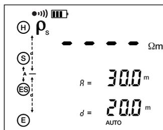
Avviate la misura premendo il bottone START/STOP.
