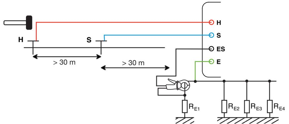
Onde evitare interferenze elettromagnetiche, si consiglia di svolgere interramente il cavo dell'avvolgitore, di posare i cavi al suolo, senza formare loop, per quanto possibile lontani gli uni dagli altri ed evitare la prossimità diretta o parallela con i condotti metallici (cavi, rotaie, recinzione, ecc).
