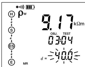
Inoltre è possibile sostituire i valori già memorizzati con valori nuovi con la medesima distanza **d** oppure aggiungere nuovi risultati con altri valori per la distanza **d** a condizione che tutti gli altri parametri della misura siano identici.
