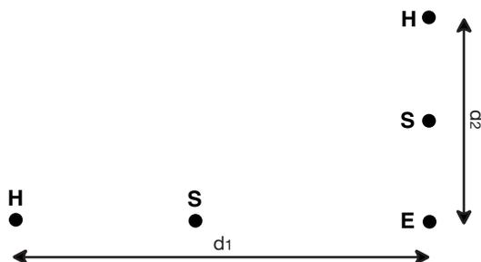
Se ottenete allora i medesimi valori, la vostra misura è affidabile. Se i valori misurati differiscono sensibilmente, è probabile che correnti telluriche o una vena d'acqua sotterranea abbiano influenzato la vostra misura. Può anche rivelarsi utile piantare i picchetti più profondamente e/o inumidire la loro ubicazione per diminuire la loro resistenza di contatto con il suolo.
