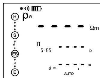
Programmate la distanza **d** e avviate la misura premendo il bottone START/STOP.
