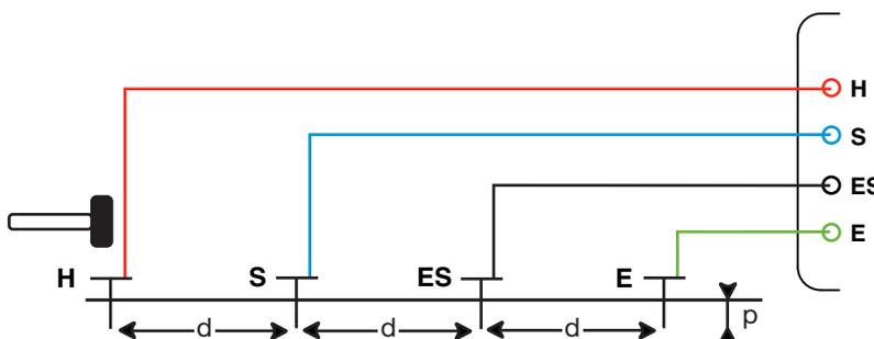
Onde evitare interferenze elettromagnetiche, si consiglia di svolgere interamente il cavo dell'avvolgitore, di posare i cavi al suolo, senza formare loop, per quanto possibile lontani gli uni dagli altri e di evitare la prossimità diretta o parallela con i condotti metallici (cavi, rotaie, recinzione, ecc).
