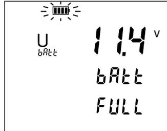
Prima del primo utilizzo caricate completamente la batteria. La carica va effettuata fra 0 e 40°C.
