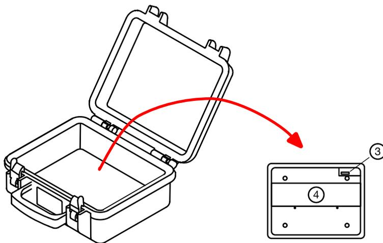
4. Se dovete sostituire solo il fusibile del morsetto H, andate direttamente al seguente punto 9. Se volete sostituire anche il fusibile dell'ingresso della pinza ES, svitate le due viti dello sportello batteria e rimuovetela.
