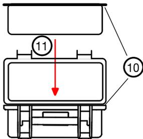
11. Collocate il corpo dello strumento nella scatola, chiudete il coperchio e serrate le viti di fissaggio.
