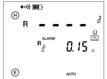
Il valore della compensazione dei cordoni di misura viene perduto non appena si ruota il commutatore.
