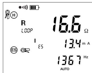
Nel caso dello schema fornito, l'impedenza di terra misurata è uguale a:
