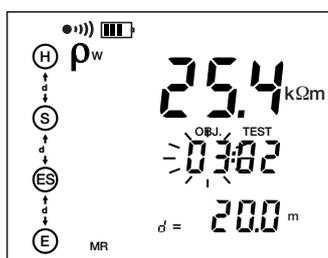
Il tasto ▲▼ permette di modificare ciò che lampeggia e il tasto ► permette di scegliere ciò che volete modificare: OBJ, TEST o il terzo criterio d'indirizzamento (la distanza nell'esempio opposto).
