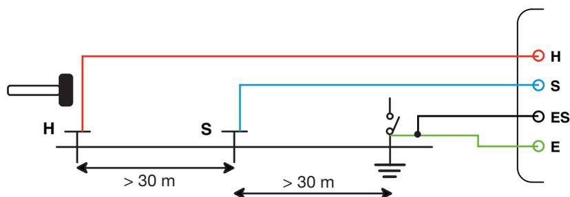
Onde evitare interferenze elettromagnetiche, si consiglia di svolgere internamente il cavo dell'avvolgitore, di posare i cavi al suolo, senza formare loop, per quanto possibile lontani gli uni dagli altri e di evitare la prossimità diretta o parallela con i condotti metallici (cavi, rotaie, recinzione, ecc). Collegate i cavi sui morsetti H e S, disinstallate il collegamento di terra e poi collegate i morsetti E e ES sulla presa di terra da controllare.
