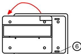
7. Rimettete al suo posto il fondo sulla faccia anteriore e l'elettronica dello strumento senza forzare i fili della batteria. Prima di abbassare il fondo, allineate i quattro fori con le quattro colonnine di fissaggio. **Attenzione:** badate che i fili della batteria (oppure altri cavi o componenti) non rimangano impigliati o compressi durante quest'operazione.
