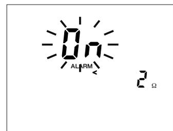
E' possibile attivare (On) il cicalino o disattivarlo (OFF).
