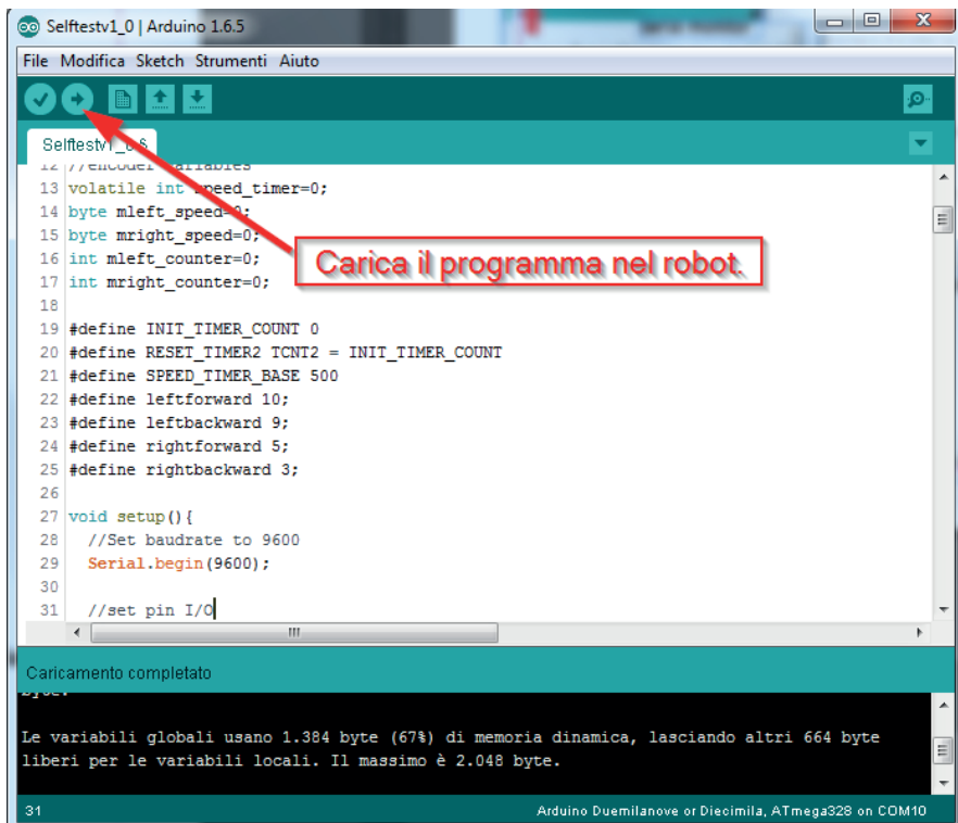
Fig.14 - Carica lo sketch nel robot
