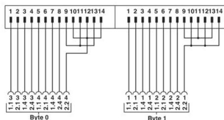
Schema di collegamento FLKM 14-PA-INLINE/OUT16
