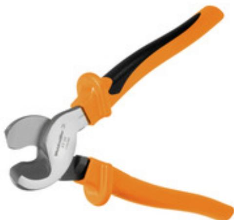
Tagliacavi per conduttori di diametro esterno fino a 8 mm, 12 mm, 14 mm e 22 mm. La speciale geometria della lama consente il taglio netto e pulito di conduttori in rame e alluminio con il minimo sforzo. I tagliacavi sono disponibili anche con isolamento protettivo verificato VDE e GS per una tensione max. di 1.000 V a norma EN/IEC 60900.
