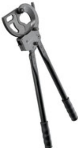
Tagliacavi nella versione a cricchetto. Adatta al taglio pulito di cavi in rame e alluminio. Minima forza manuale grazie alla trasmissione ottimale della leva e all'azionamento ad eccentrico.
