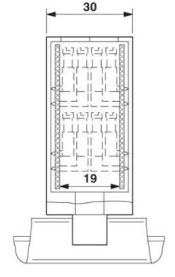
UEG 30/2, spazio interno ingrandito, con 2 c.s., disposte simmetricamente, fino a max. 16 poli
