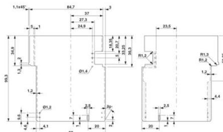
Disegno quotato del circuito stampato ME... utilizzando la parte superiore a un piano
