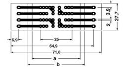
Passo da 5 mm a = superficie equipaggiabile 38 mm nella calotta b = superficie equipaggiabile 45 mm nella custodia
