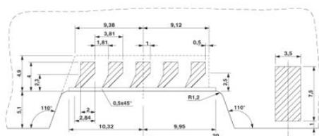
Disegno quotato dei particolari della base di contatto del connettore bus per guida di supporto
