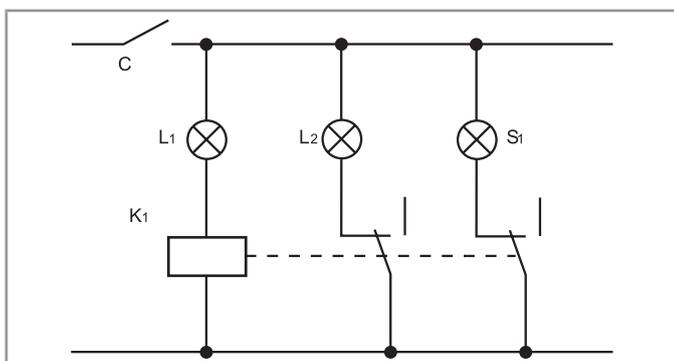
Esempio di applicazione di relè in versione amperometrica.
