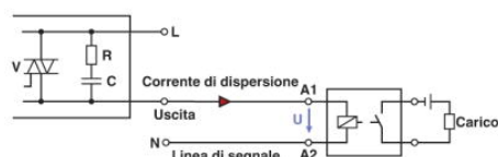
Presenza di fenomeni di disturbo Caso 1: guasto - scheda di uscita AC
