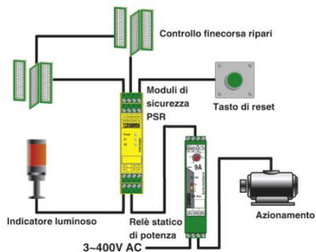
Esempio di applicazione per finecorsa ripari con un relè di sicurezza PSR PSR-ESM4.
