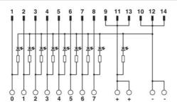
Schema di collegamento UM 45-FLK14/LA/PLC
