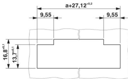
Sezione della lamiera con molla di bloccaggio.
