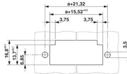
Sezione della lamiera con collegamento a vite.
